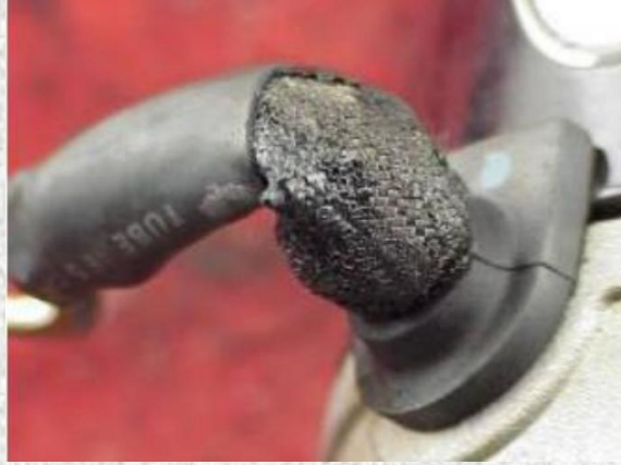
जास्त क्रँक केल्यामुळे मोटर स्ट्रॅप इन्सुलेटरचा रंग बदलला आहे.
